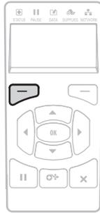
Pressione SELECIONAR DA ESQUERDA para voltar ao menu Início. Automaticamente a impressora volta ao menu Início após 15 segundos de inatividade do menu do usuário.
