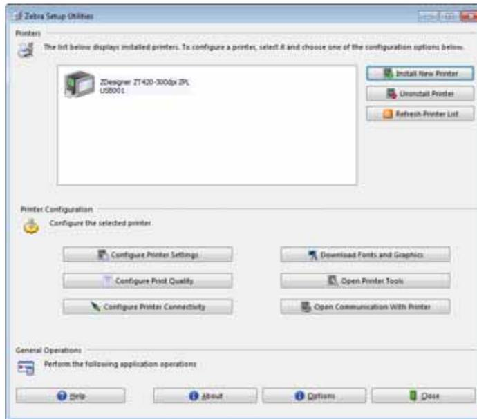
5. Clique em "Install New Printer" (Instalar nova impressora).
